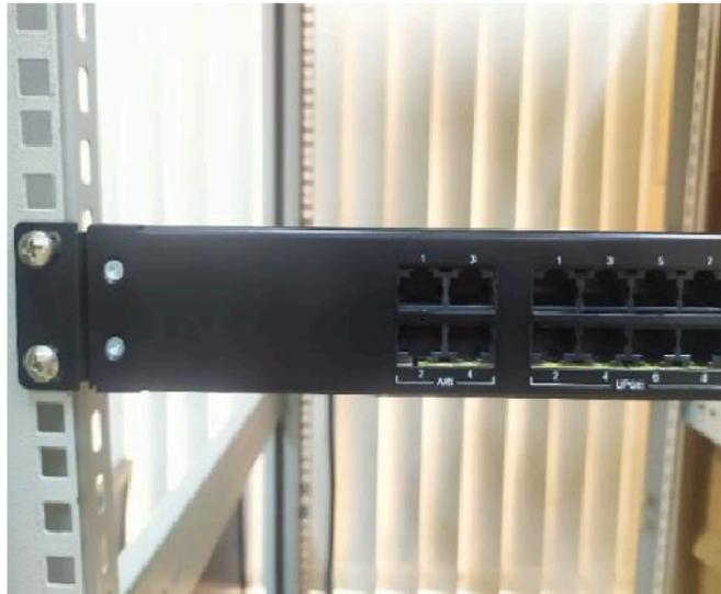
Abbildung 12: Beispiel: 19-Zoll-Befestigung (vertikale Schiene)
