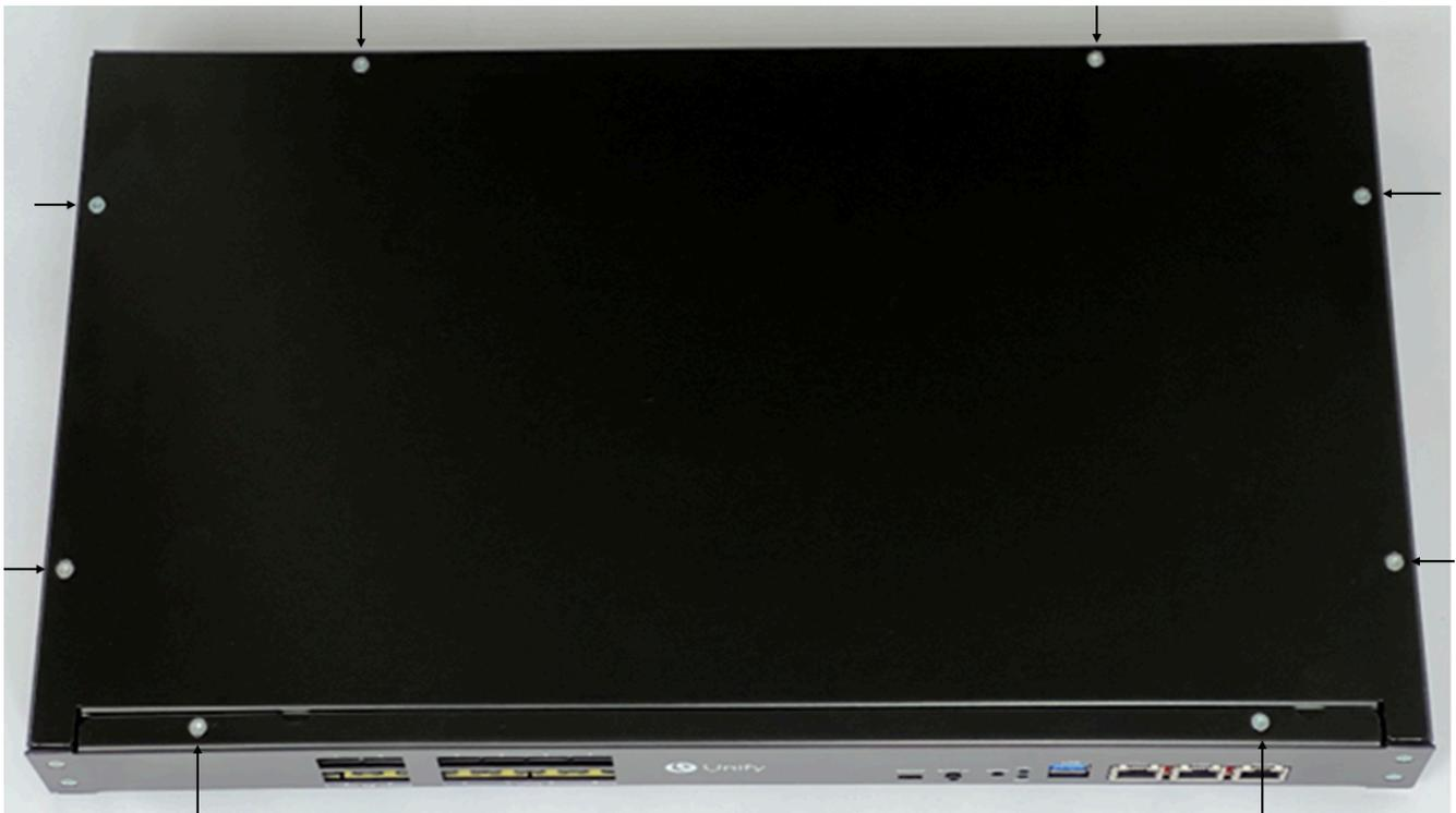
3) Heben Sie die Abdeckung leicht an, um sie aus der Verriegelungsposition zu lösen, und schieben Sie die Abdeckung dann zur Vorderseite des Gehäuses.
