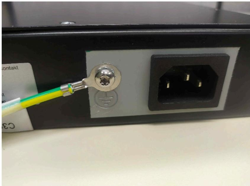
Abbildung 2: Montage der Schutzerdungsklemme
